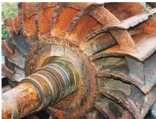
Figura 10. Sistema de pintura que cumplió su vida útil. Engranaje máquina industrial utilizada en un ingenio
