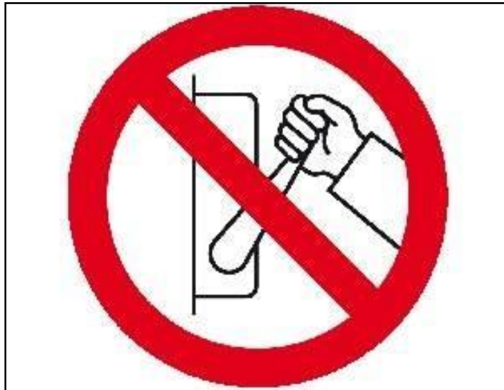
Figura 9. Prohibición maniobrar instalaciones eléctricas en paredes
