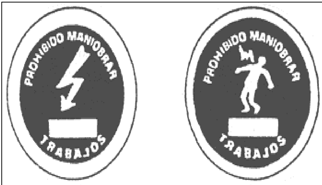
Figura 8. Prohibición de maniobrar trabajos
