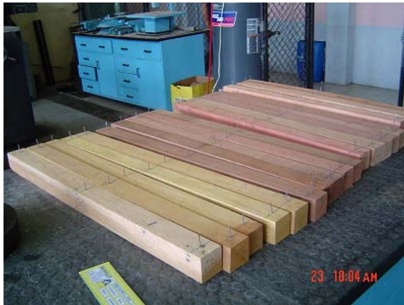
Figura 21. Probetas para ensayo de flexión, previas a ser ensayadas.
