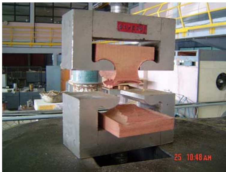
Figura 37. Se muestra el momento de la falla por tensión simple.
