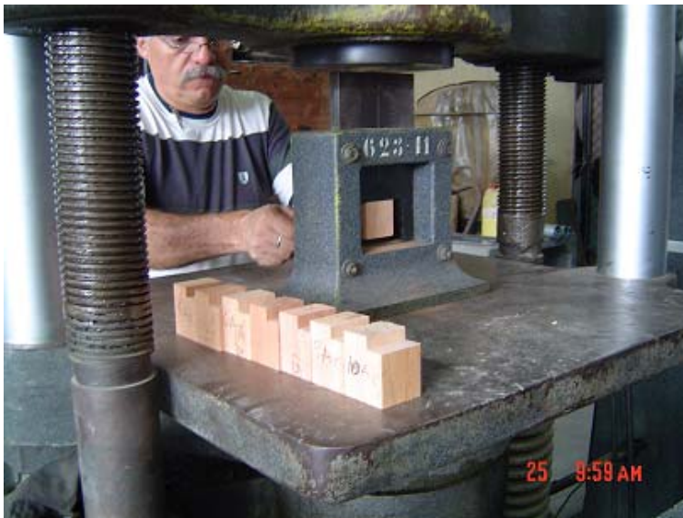
Figura 31. Se observa el momento en que la probeta es sometida a la aplicación de carga, por medio de dispositivo
