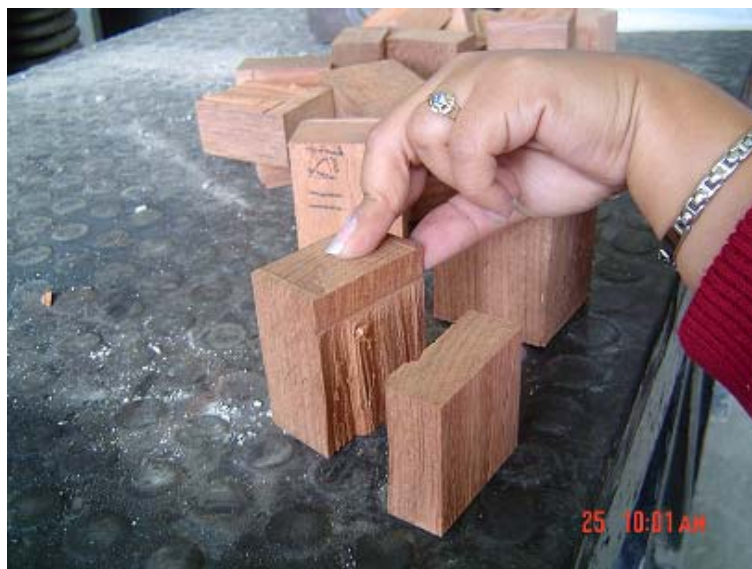
Figura 32. Se observa el tipo de falla en probeta por medio del ensayo de corte.
