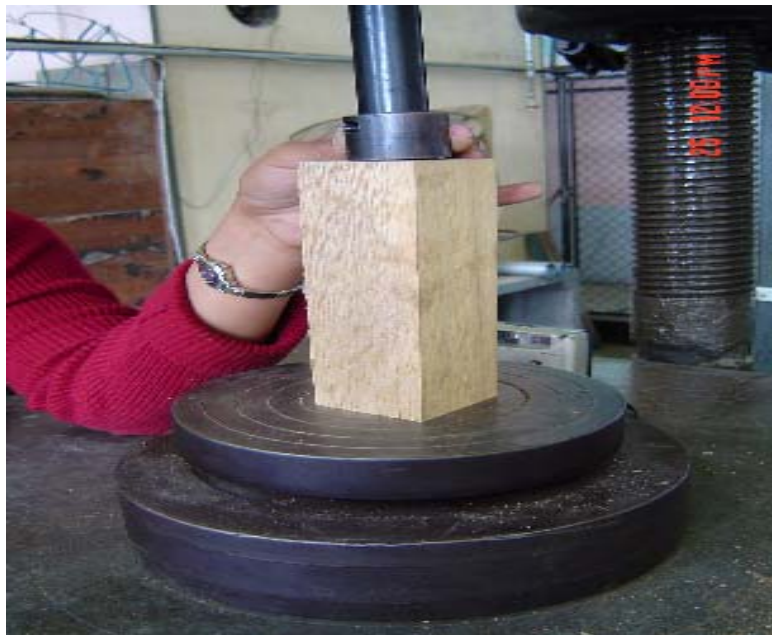
Figura 40. Penetración en borde de probeta
