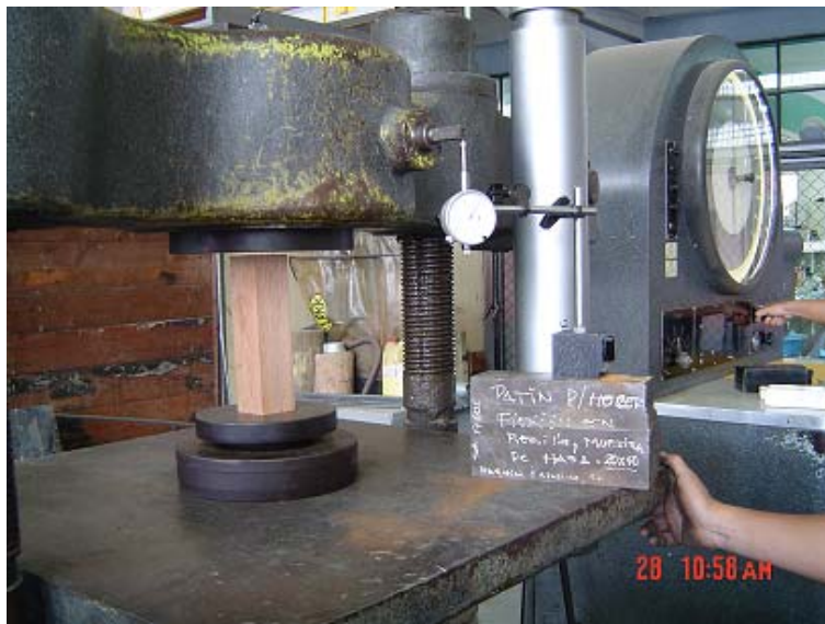
Figura 25. Probeta sometida a la aplicación de carga
