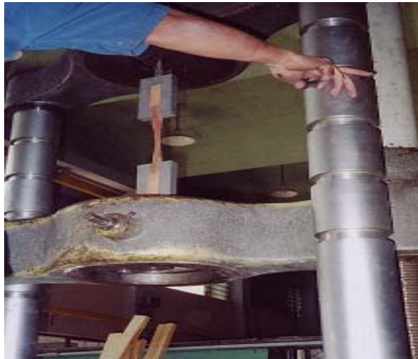
Figura 34. Probeta sometida a carga por medio de mordazas
