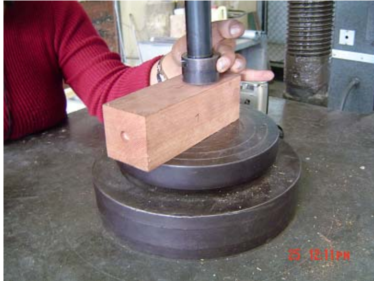
Figura 39. Probeta sometida a ensayo de dureza, en sentido radial.
