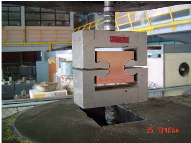
Figura 36. Probeta sujeta por medio de quijadas para la aplicación de carga.
