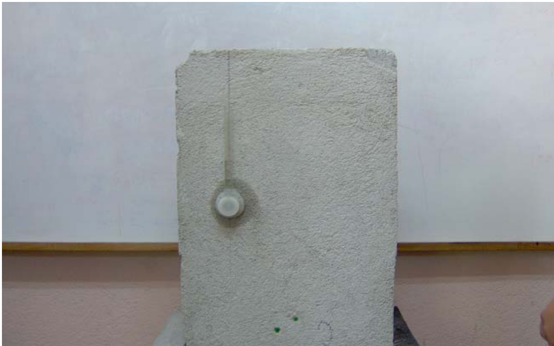
Fotografía 44. Evaluación de la permeabilidad mortero de acabado
