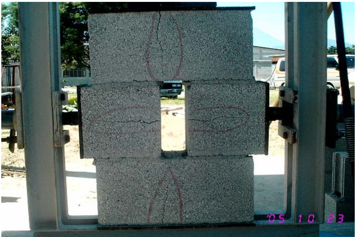
Figura 53. Falla inicial presentada en los prismas para la evaluación de adherencia sabieta-cal
