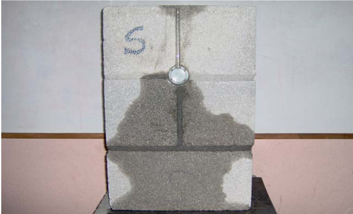
Fotografía 43. Evaluación permeabilidad junta mortero-unidad
