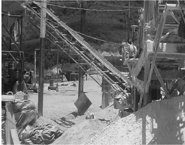
Figura 6. Proceso para obtener el agregado grueso
