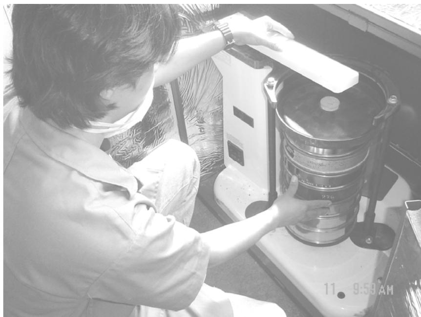
Figura 10. Tamizadora para agregado grueso con tamices de 2", 1 1/2", 1", 3/4", 1/2", 3/8", y No.4 y fondo.
