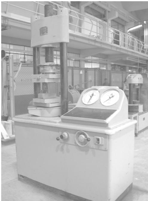
Figura 3. Máquina con sistema para compresión de bloques de concreto.
