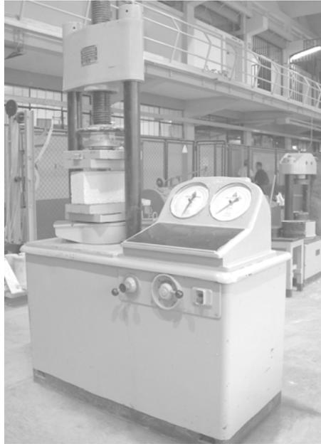
Figura 4. Máquina Universal con sistema para flexión de adoquines.
