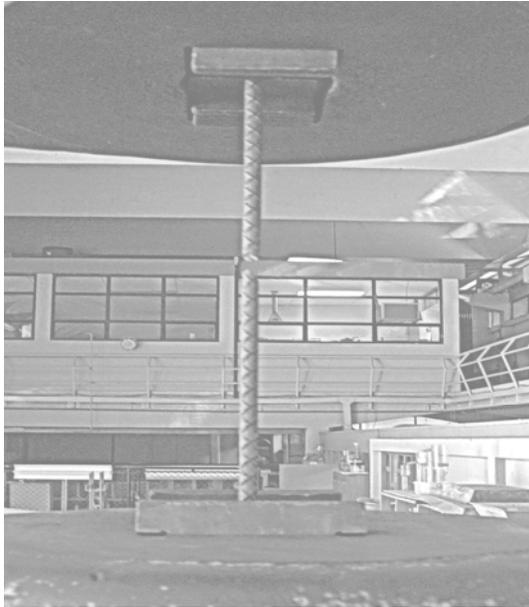
Figura 2. Máquina con sistema para compresión de ladrillos de barro.
