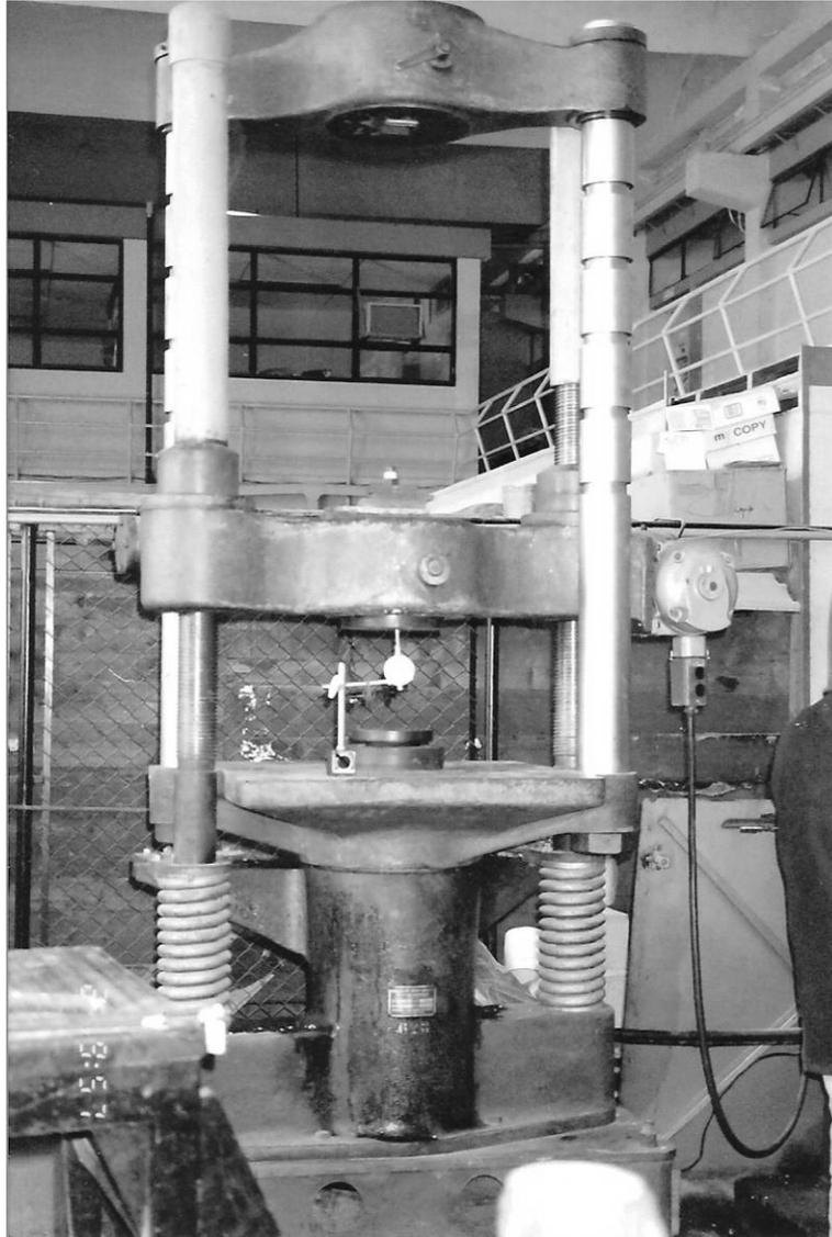
**Figura 32. Máquina universal de carga para ensayo de flexión estática.**
