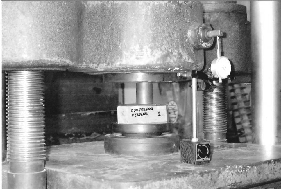
**Figura 38. Aplicación de carga en ensayo de compresión perpendicular**
