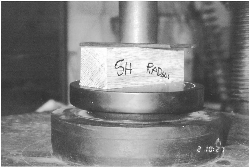
Figura 39. Ensayo de compresión paralela a la fibra, falla por aplastamiento
