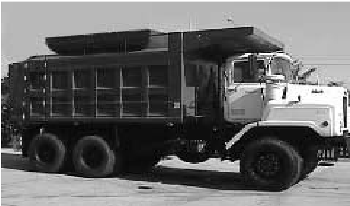
Figura 34 Camión de volteo
