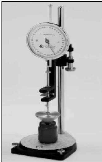
Figura 16. Penetrómetro de cono
