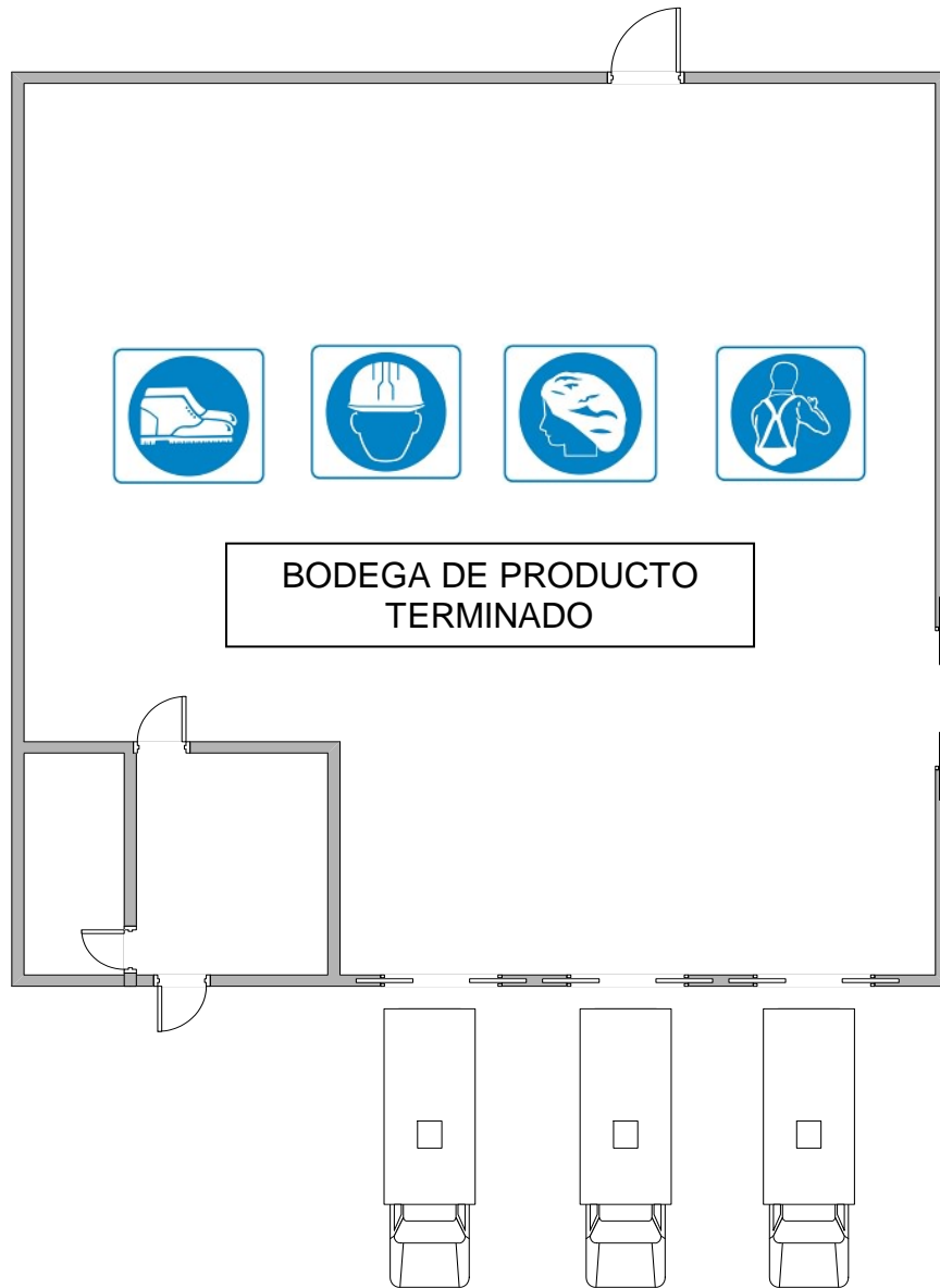
Figura 32. Distribución señales de obligatoriedad
