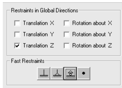
Figura 77. Restricción de un grado de libertad
