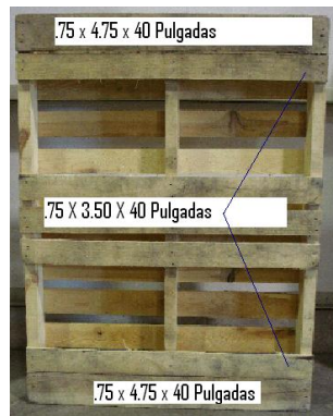
Figura 8. Vista de tarima de madera con sus dimensiones
