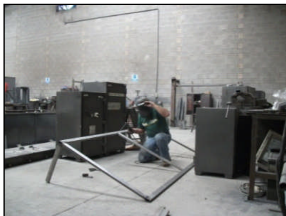
Figura 38. Elaboración de mesa inclinada por el autor para la cortador (CINCINNATI)
