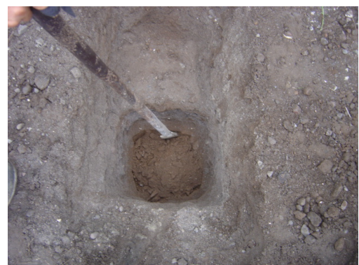
Figura 20. Fotografías de excavación de pozos a cielo abierto para muestrear los materiales del pavimento
