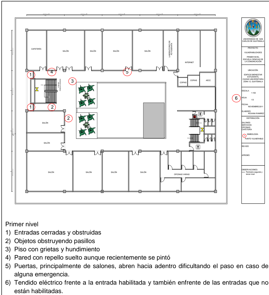
Figura 88. Plano de identificación de vulnerabilidades en el primer nivel del edificio Bienestar Estudiantil
