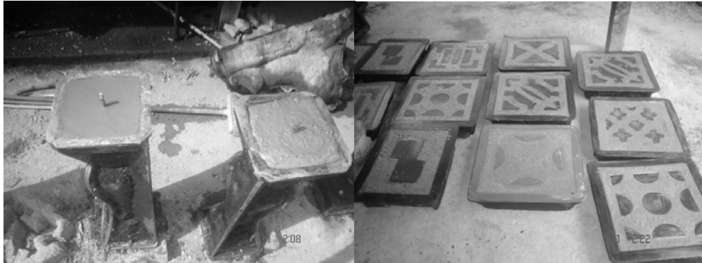
Desencofrado sin impacto.
