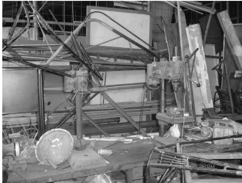
Figura 7 Barrenos de pedestal
