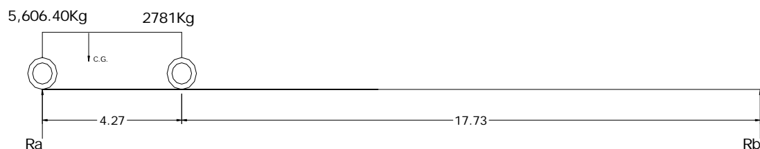
Figura 8. Diagrama de posición de cargas que producen corte máximo
