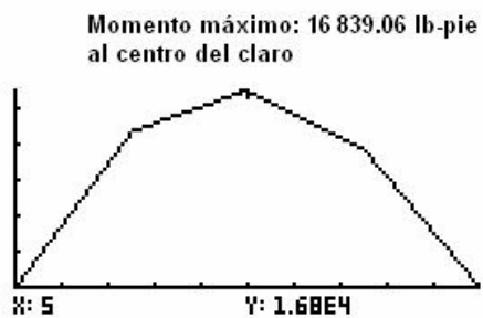
Figura 70. Diagrama de momentos horizontales en viga crítica
