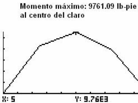
Figura 67 . Diagrama de momentos verticales en viga crítica
