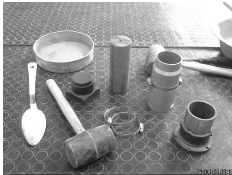
Figura 24. Accesorios para la preparación de la muestras remoldeadas para el ensayo de triaxial
