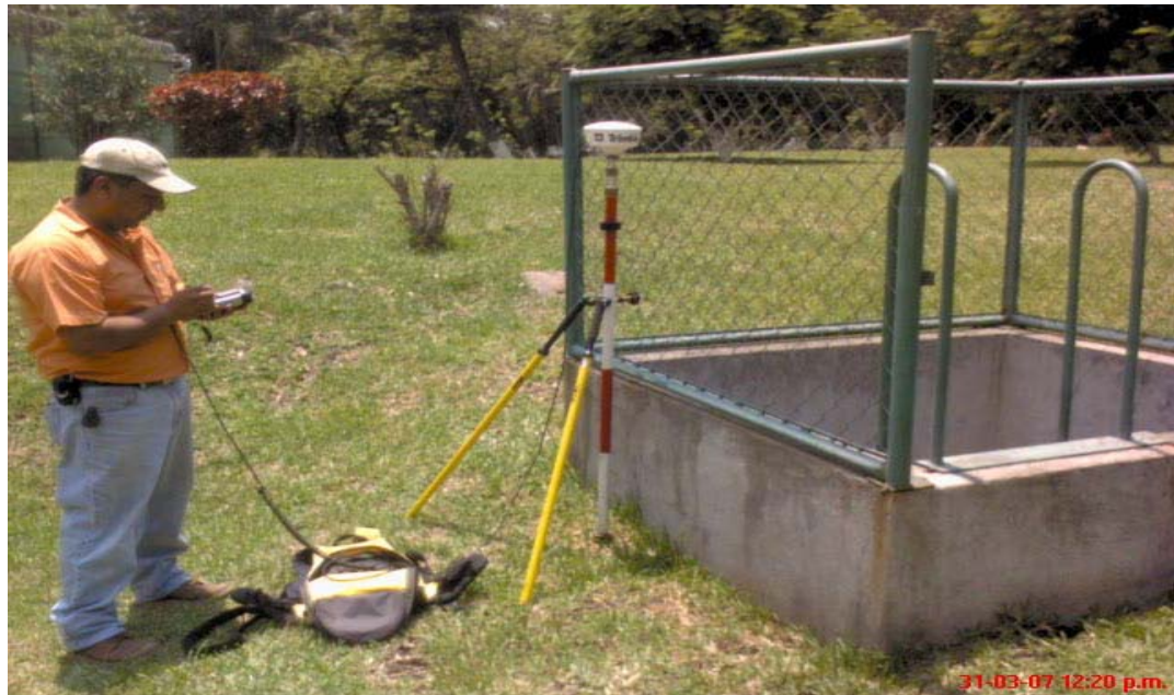
Figura 1. Equipo utilizado para realizar un levantamiento catastral.
