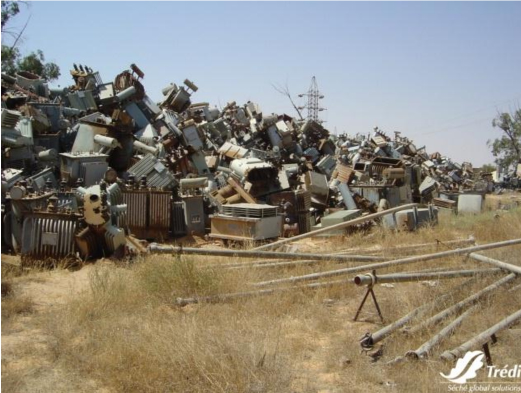
Figura 26. Desechos producidos por la liquidación de transformadores
