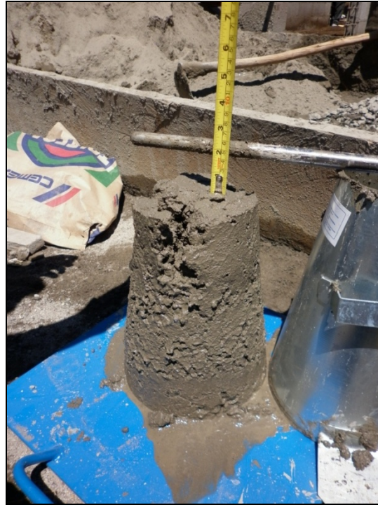
Figura 27. Medición del asentamiento de concreto
