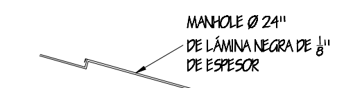
DETALLE DE MANHOLE
