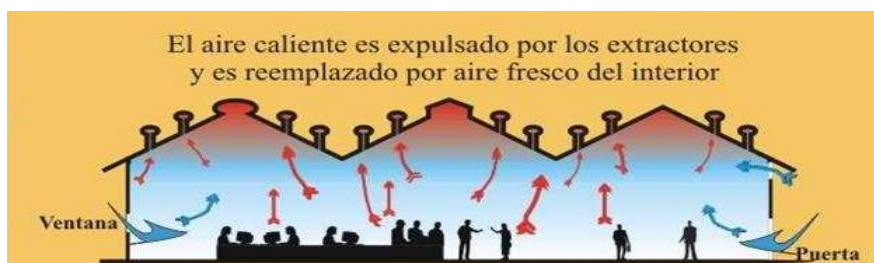
Figura 13. Sistema de renovación de aire
