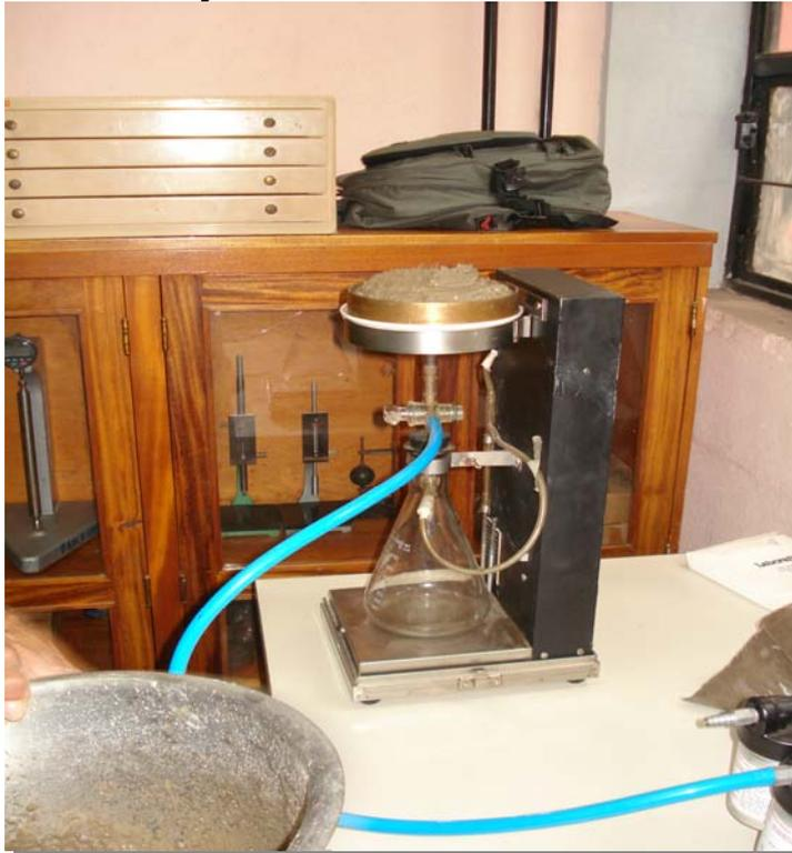
**Figura 2** Presión aplicada en ensayo de retención de agua ASTM C-1506
