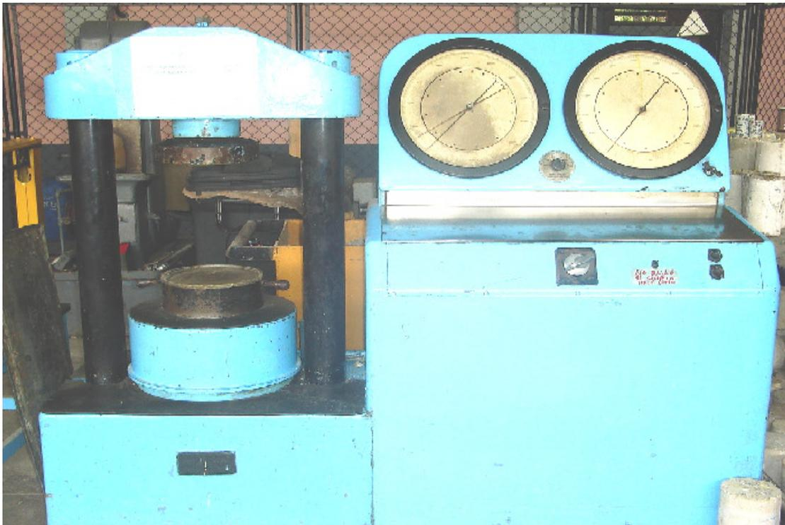
**Figura 2. Máquina universal, ensayos de flexión de probetas de concreto**
