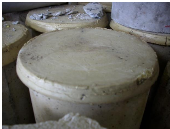
Figura 24. Probeta de concreto con placa de azufre
