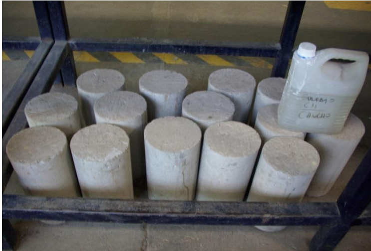
Figura 3. Probetas o cilindros de concreto
