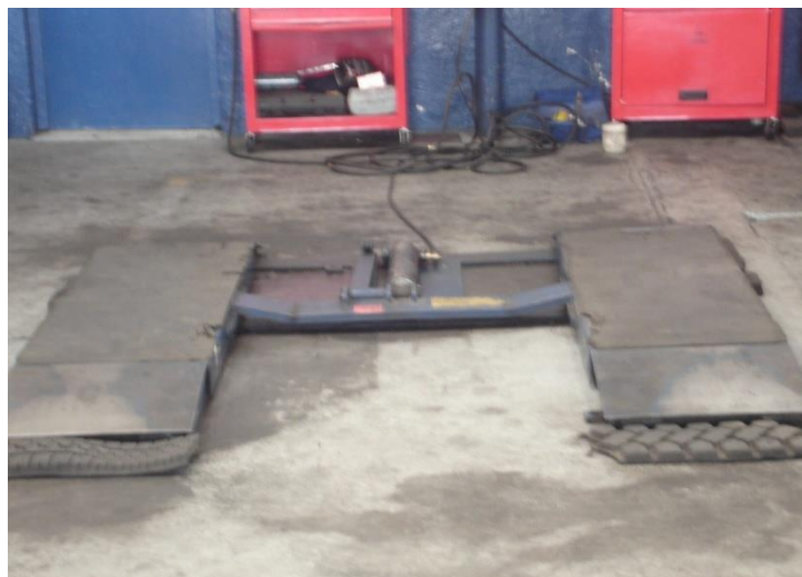
Figura 10. Puente frenero No. 1
