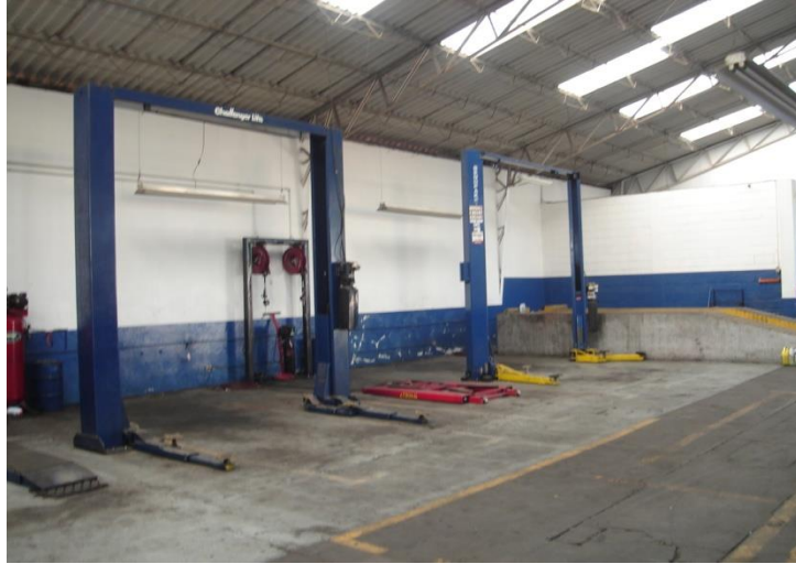
Figura 9. Puente de dos columnas
