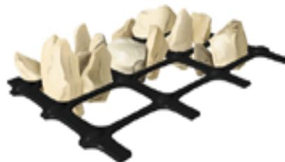
La geomalla BIAXIAL es una malla estructural teniendo aperturas en las que el material granular es confinado por trabe. La reducida deformación en la capa base limita la formación de “fracturas” en los elementos encontrados debajo de la misma base. En suelos de arena de grano fino o arcillas, es recomendable el uso de una geomalla fina multi-capas.
