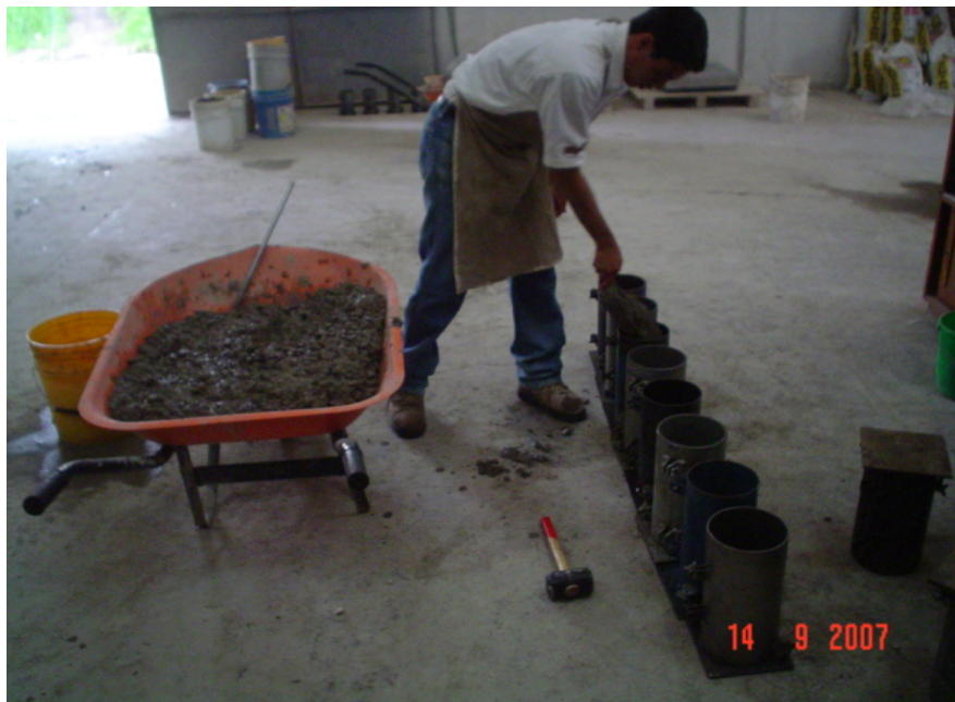
Figura 9 Elaboración de especímenes, ensayo resistencia compresión
