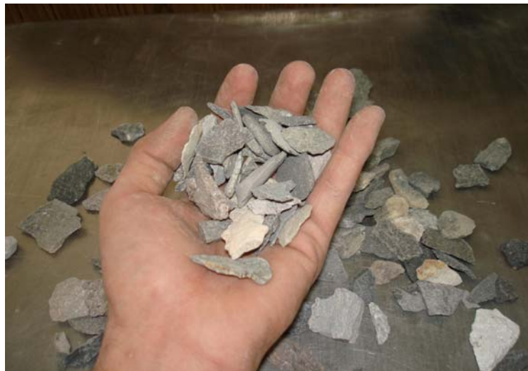
Figura 1 Agregado grueso con características de forma plana y alargado
