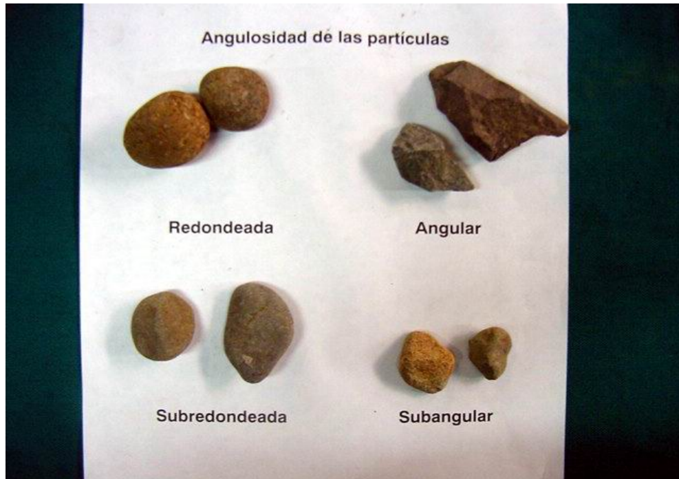
Figura 2 Agregado grueso con características de forma redondeada y angular
