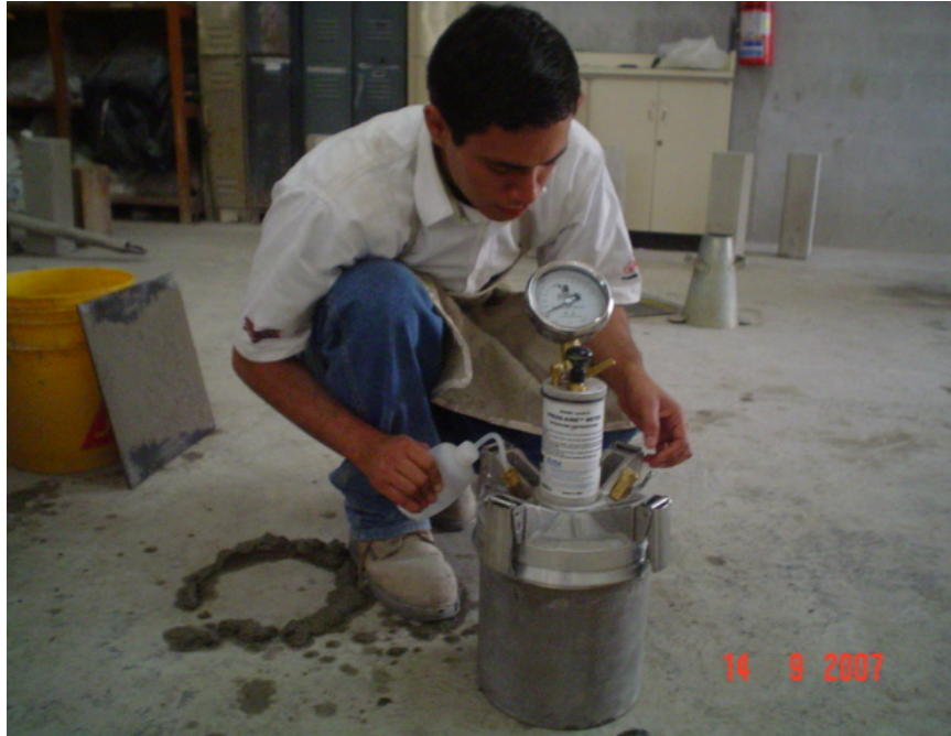
Figura 8 Ensayo contenido de aire, método de presión
