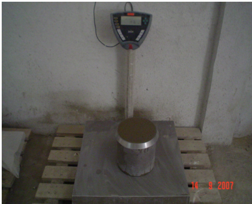
Figura 7 Ensayo densidad del concreto
