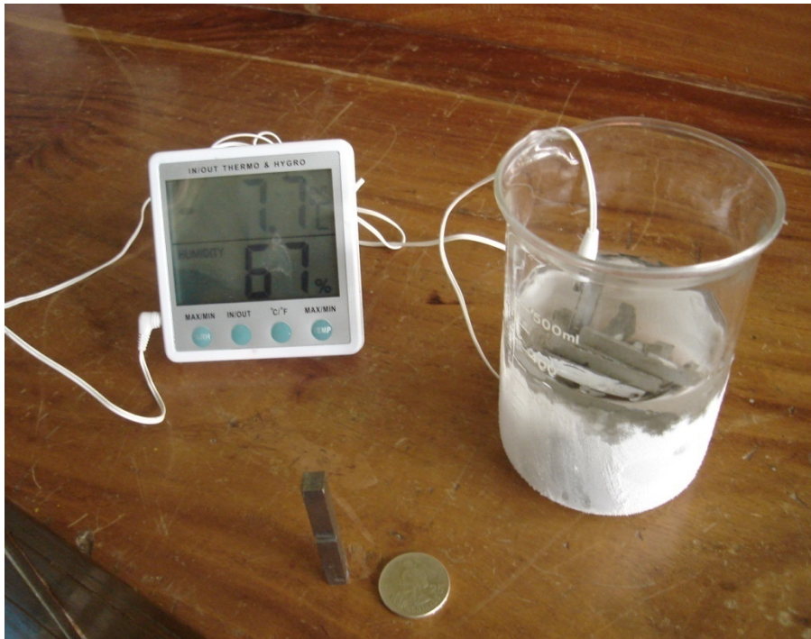
Figura 3 Condiciones probeta, Ensayo de impacto Charpy
