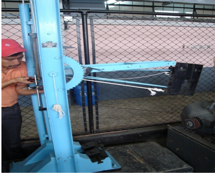
Figura 4 Máquina ensayo impacto Charpy
