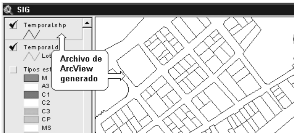
Figura 52 Archivo o tema de líneas de ArcView , creado a partir de un archivo de tipo DXF.
