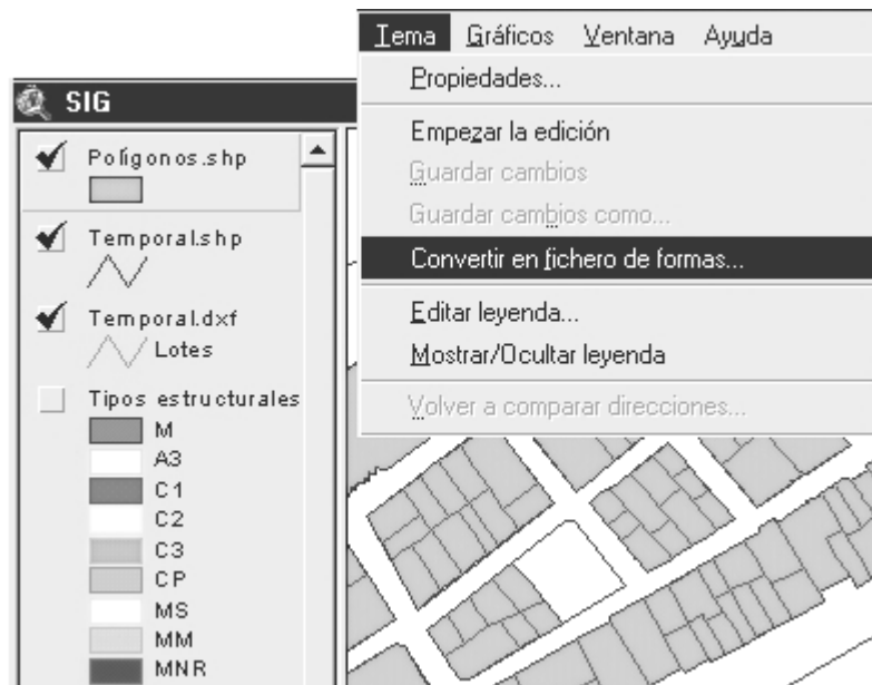
Figura 55 Opción utilizada para crear una nueva capa de información a partir de una existente, en el ambiente ArcView .
