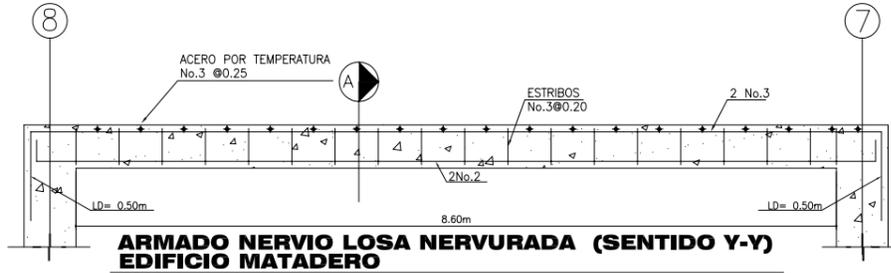
**ARMADO NERVO LOSA NERVURADA (SENTIDO Y-Y) EDIFICIO MATADERO ESCALA 1=20**
