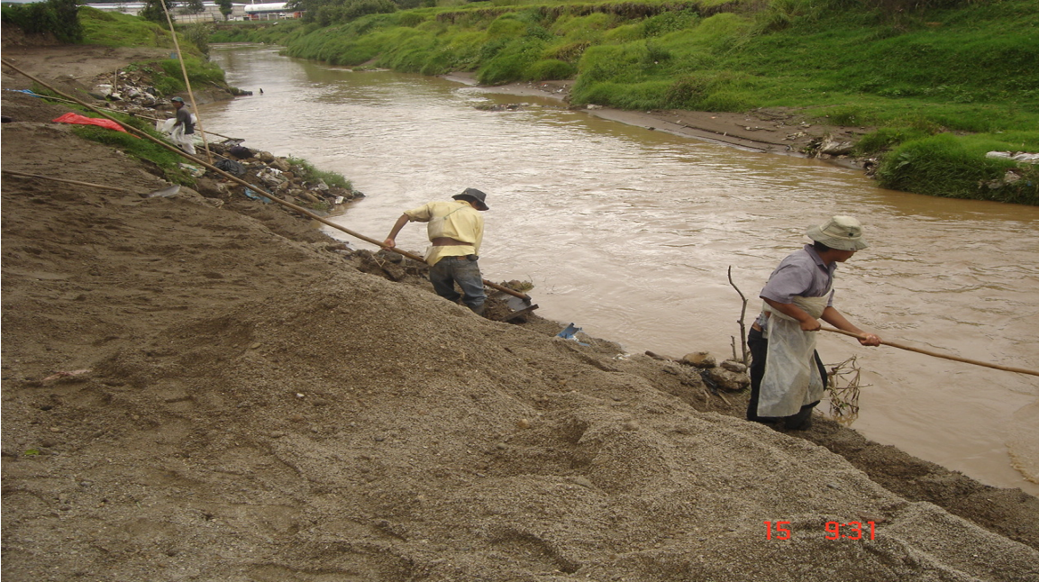
Figura 8. Fotografía de forma rudimentaria de extracción de agregado fino
