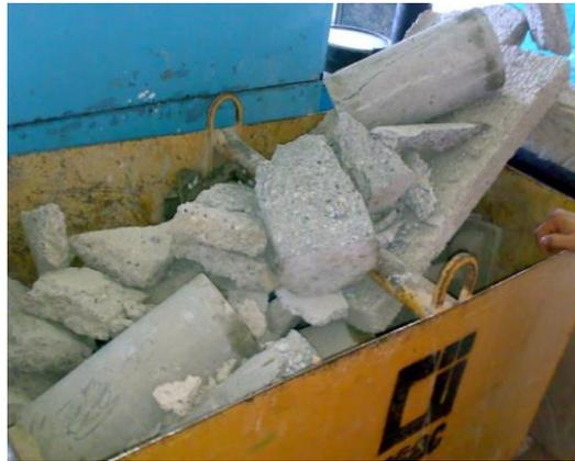
Fuente: CII, Sección de Agregados y Concretos; estudios de calidad para el ensayo de Cilindros de Concreto.
