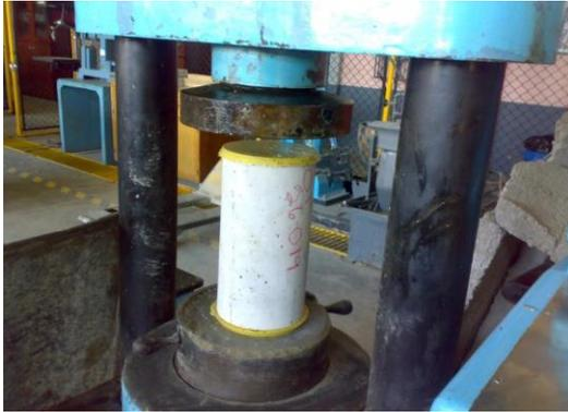
Fuente: CII, Sección de Agregados y Concretos; estudios de calidad para el ensayo de Cilindros de Concreto.
