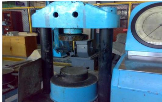
Fuente: CII, Sección de Agregados y Concretos; estudios de calidad para el ensayo de Cilindros de Concreto.
