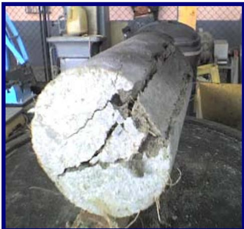
**Figura 38. Falla a tensión en espécimen sin refuerzo**
