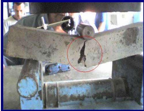
**Figura 36. Falla a flexión se puede observar como las fibras trabajaron**
