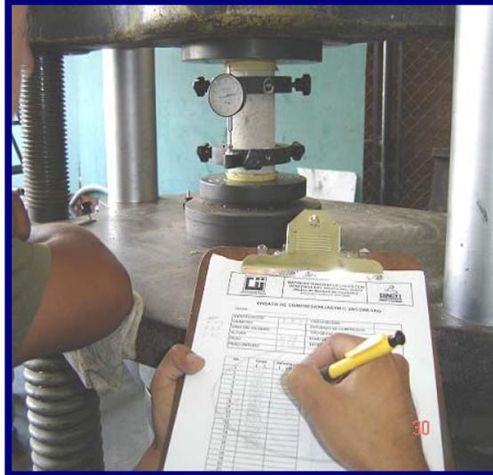
Según la Norma ASTM C 39/C39M – 04a (método de ensayo para resistencia a compresión de especímenes cilíndricos de concreto), el esfuerzo a compresión se calcula por medio de la siguiente fórmula:
