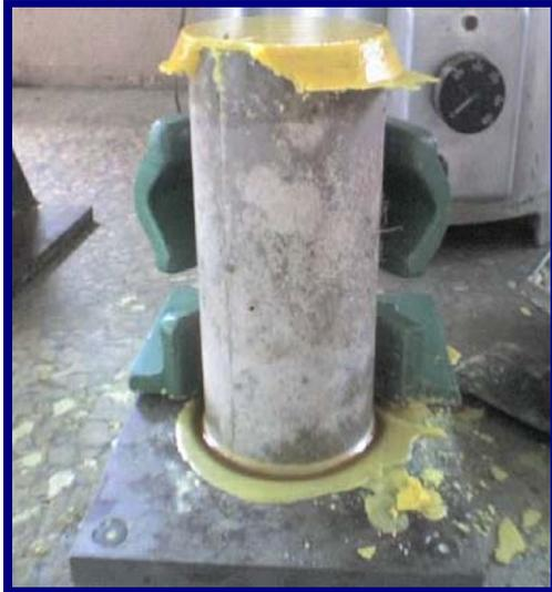
**Figura 16. Realización del ensayo a compresión**
