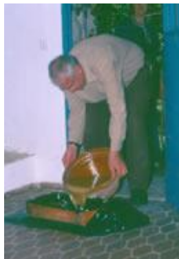
Figura 37. Vertimiento de mezcla para jabón
