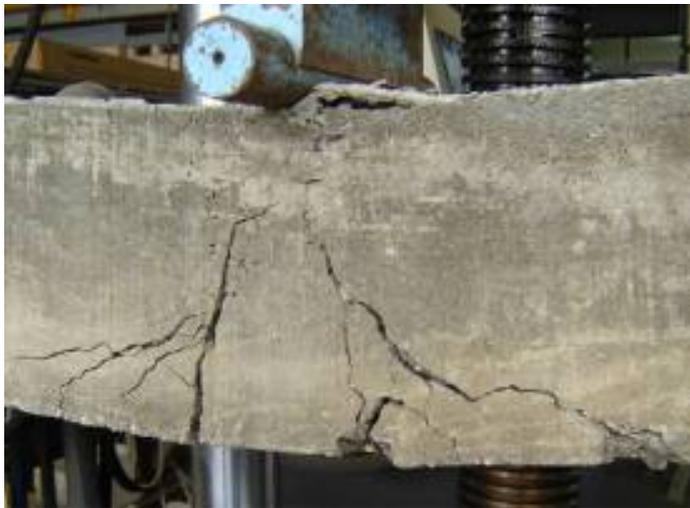
**Figura 28. Ensayo en viga con refuerzo de fibra de carbono**
