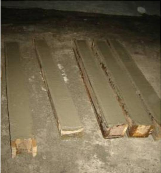
**Figura 16. Curado de vigas de concreto armado**
