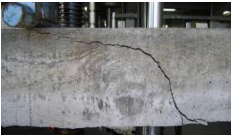
**Figura 29. Ensayo en viga sin refuerzo de fibra de carbono**
