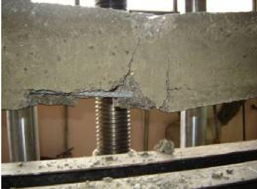
**Figura 30. Ensayo en viga con refuerzo de fibra de carbono**
