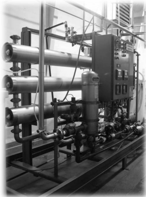
Figura 40. Ósmosis inversa – membranas tubulares
