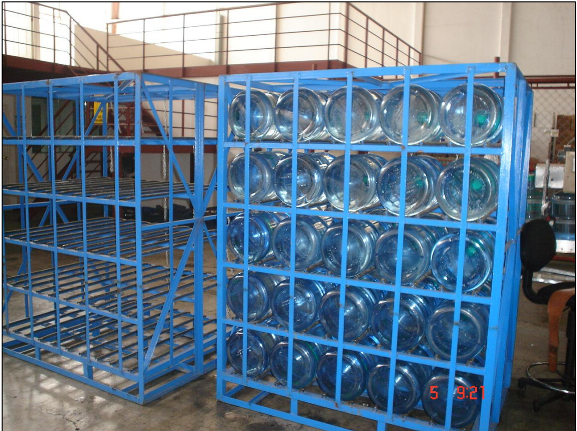
Figura 7. Sección posterior de la estructura para almacenaje y transporte de garrafones (rack)
