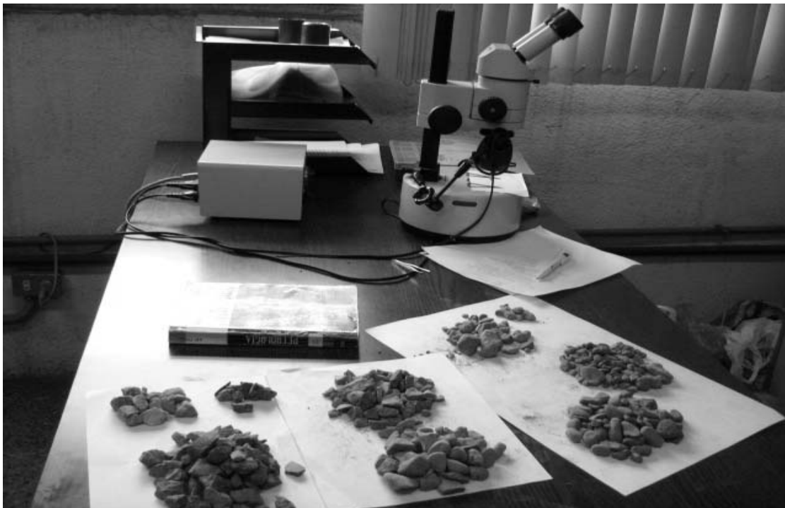
Figura 8 Análisis del agregado grueso con el auxilio del microscopio estereoscópico
