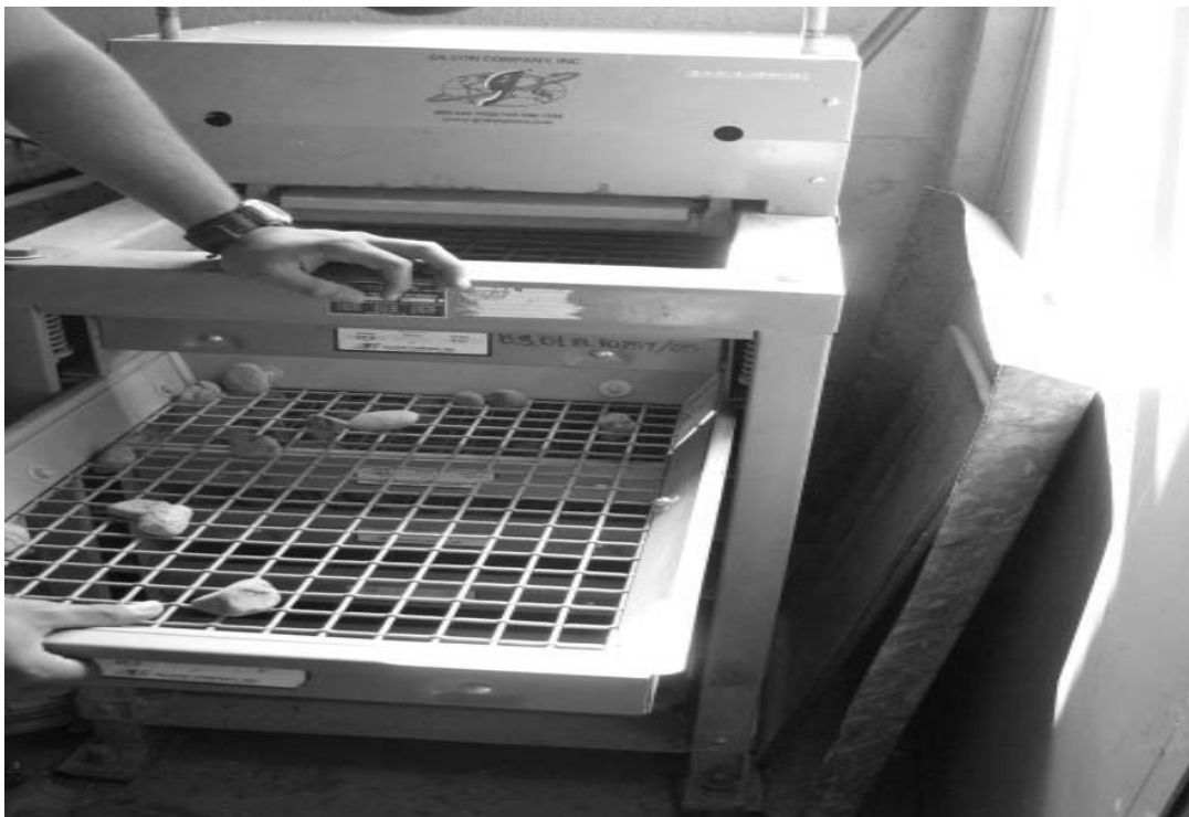
Figura 7 Proceso de tamizado de los materiales (agregado grueso)
