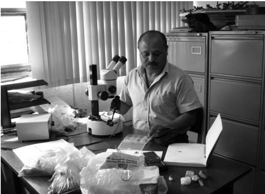
Figura 9 Clasificación del agregado fino con el auxilio del microscopio estereoscópico
