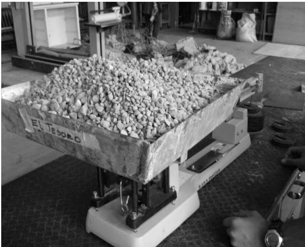
Figura 6 Pesando el material que será utilizado en cada una de la pruebas del laboratorio
