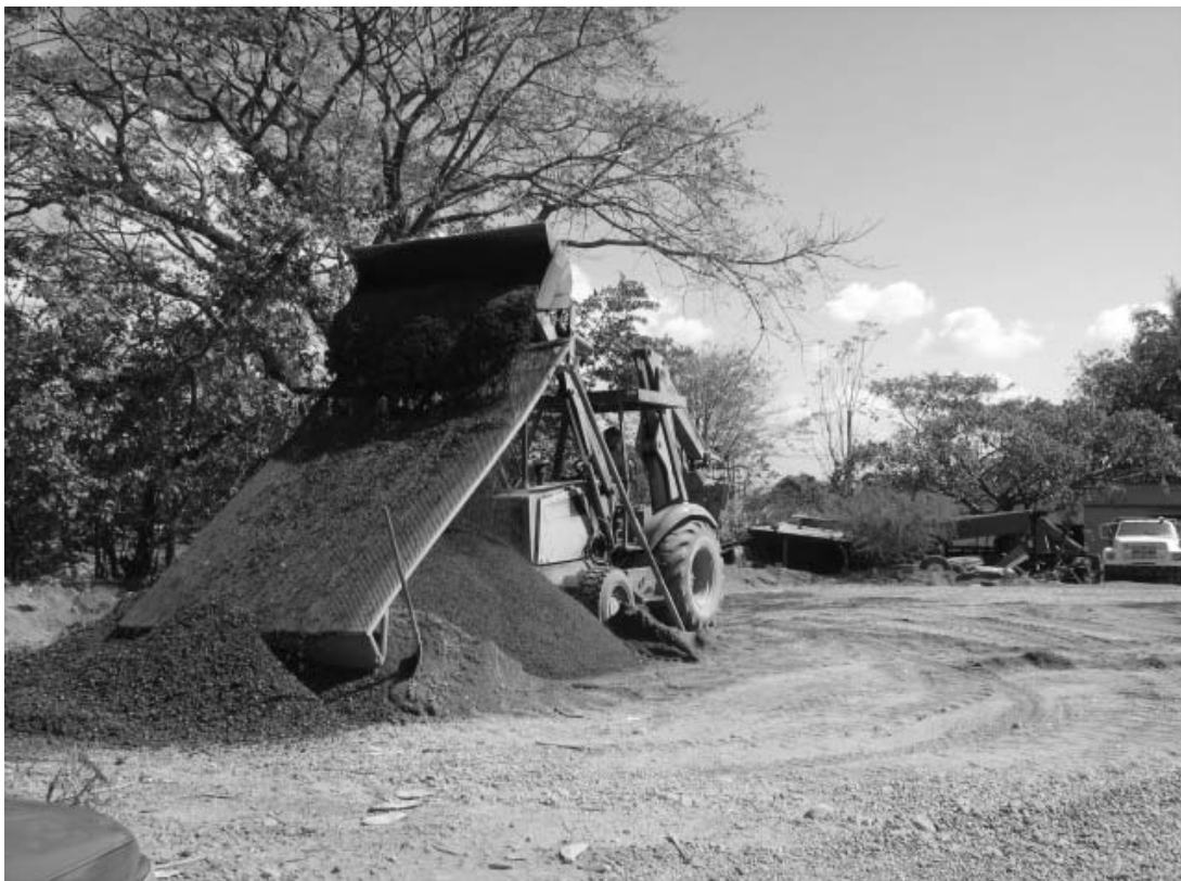
Figura 4 Tamizado del material del río Ostúa para apilarlo y ponerlo a la venta
