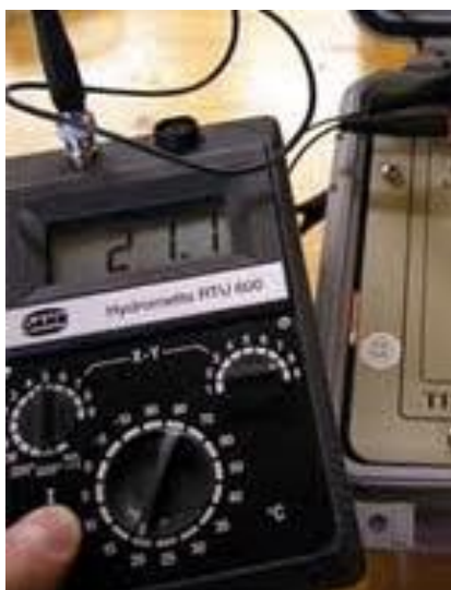
Figura 39. Xilohigrómetro para determinar la humedad en madera
