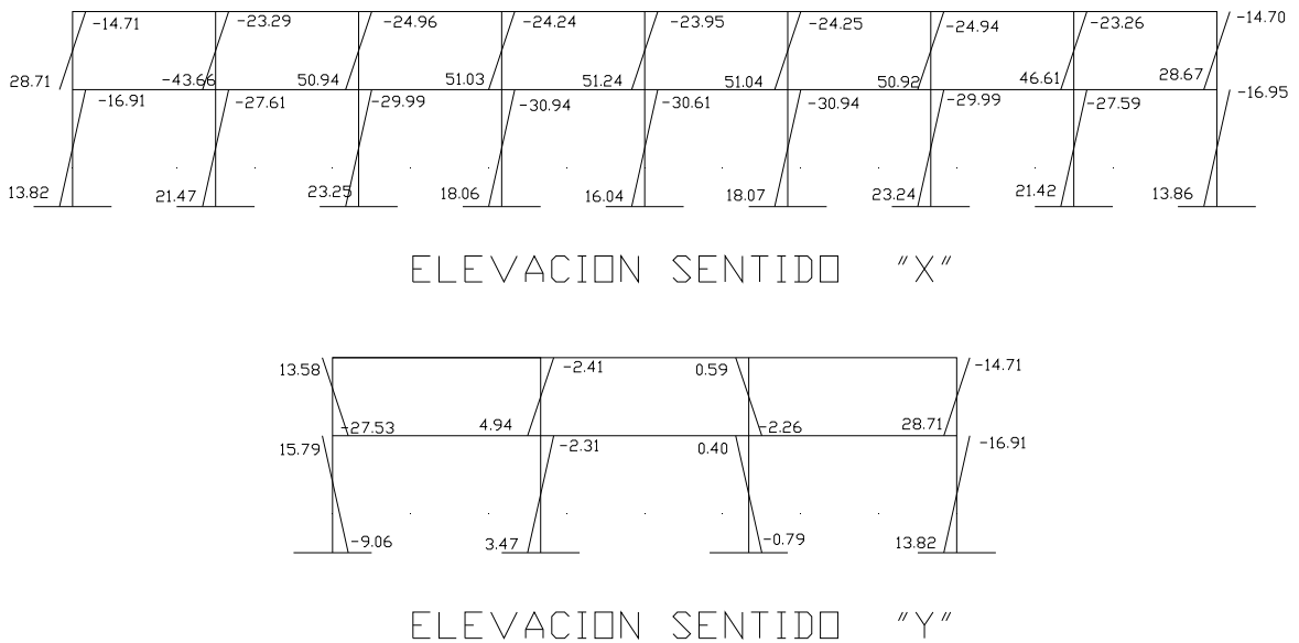
Figura 17. Diagrama de momentos últimos en columnas (T-m)
