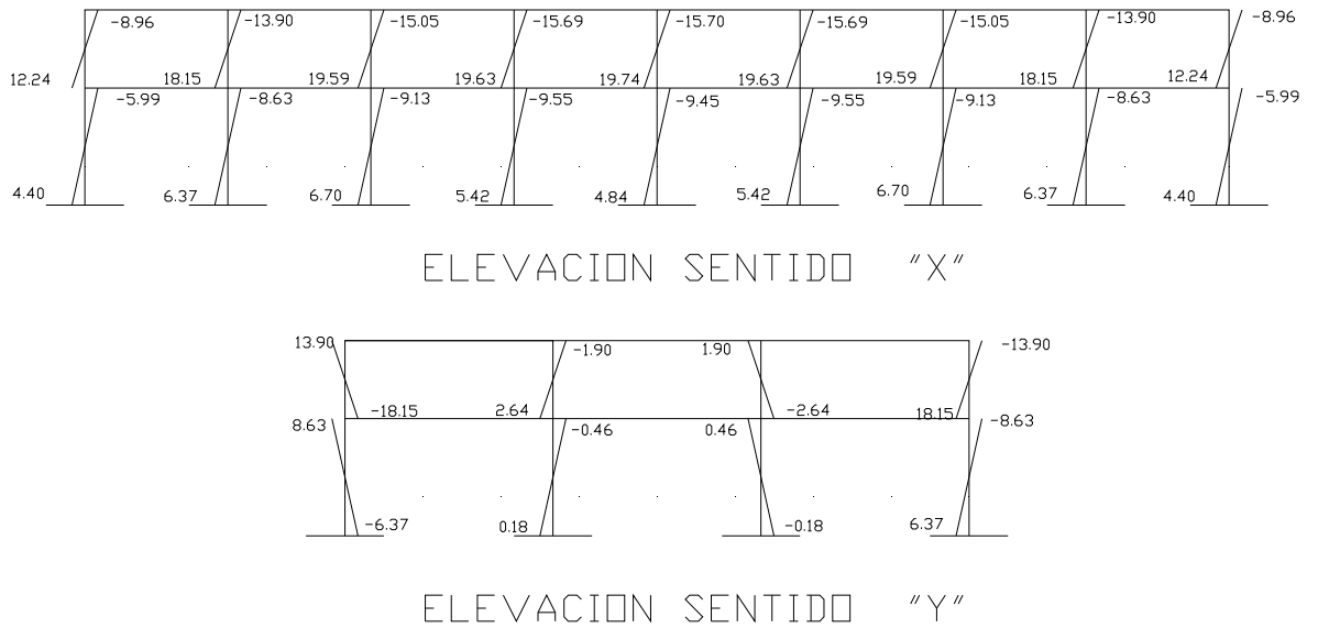
Figura 14. Diagrama de momentos en columnas para cargas muertas (T-m)
