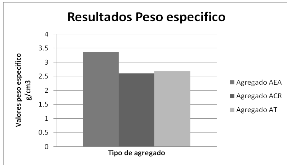
Figura 10 Resultados peso específico, agregado grueso (Apéndice 1)
