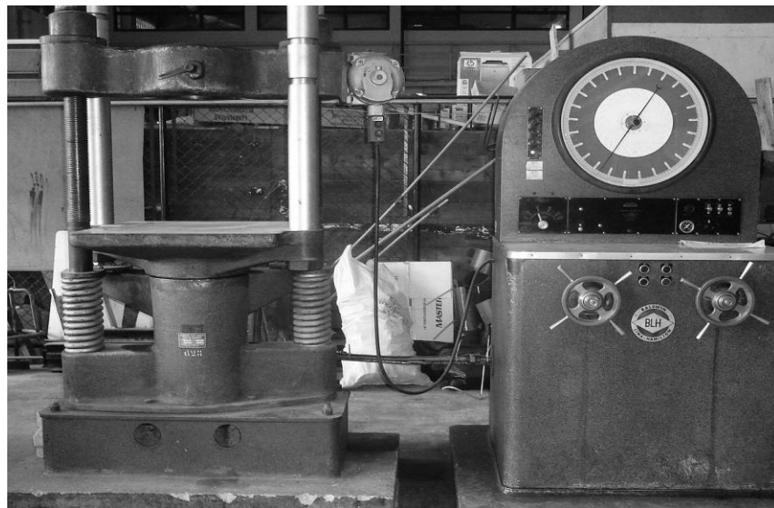
Figura 21 Máquina universal del Centro de Investigaciones e Ingeniería de la Universidad de San Carlos (Ensayo de adherencia)
