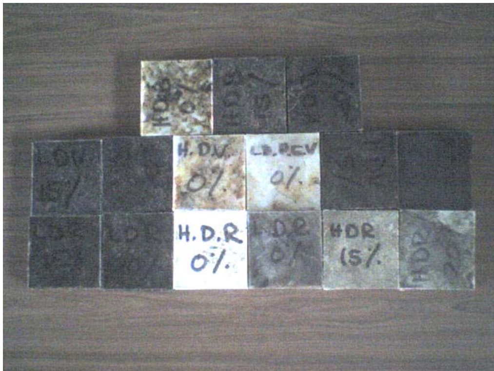
Figura 26. Tableros para ensayos de absorción
