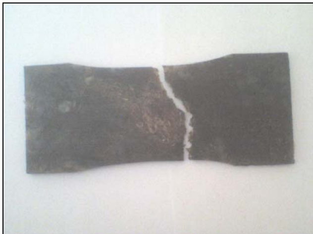
Figura 35. Falla oblicua de una probeta ensayada a tracción
