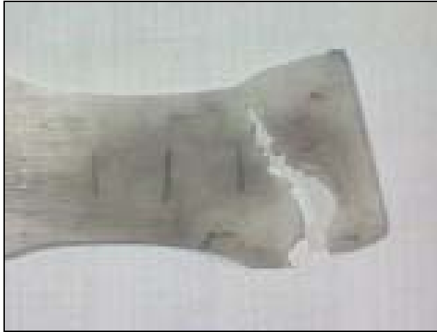
||Figura 34. Falla en el extremo de una probeta ensayada a tracción
