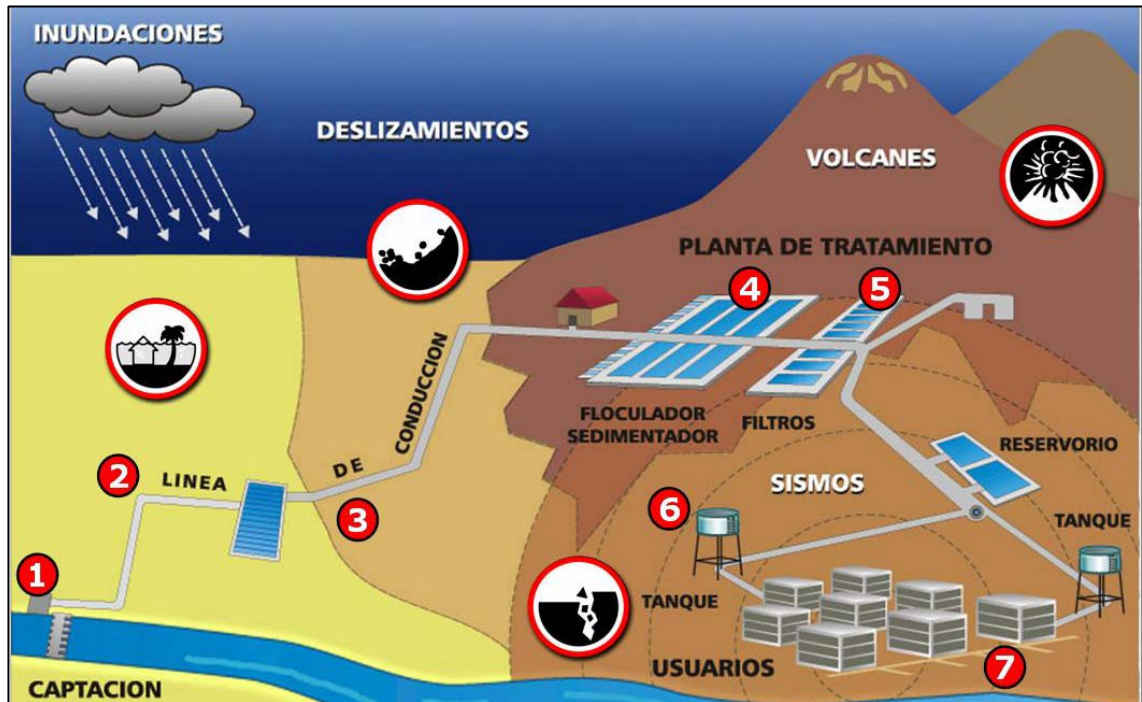
Figura 24. Componentes de un sistema de Agua Potable.
