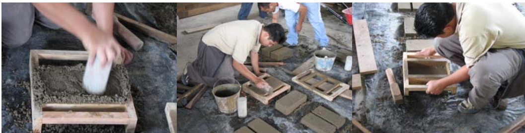
Figura 4. Fases del proceso de producción de un ladrillo de suelo-cemento.
