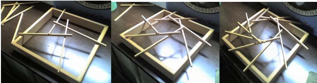
Figura 36. Secuencia fotográfica de un modelo a escala con las diferentes estructuras que se pueden obtener variando el número de barras.
