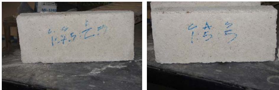
Figura 2. Imagen de dos bloques con distintas dosificaciones de cemento, arena pómez y ceniza volcánica
