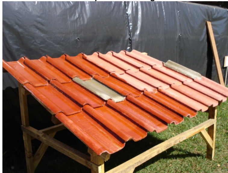
Figura 48. Cubierta de teja TEVI con aplicación de Resina poliuretana Vegetal
