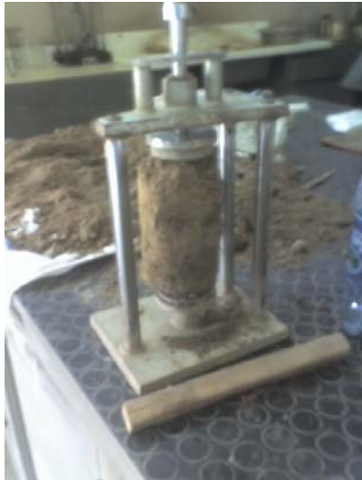
Figuras 9. Cilindro para ensayos triaxiales. Se talla la muestra, formando un cilindro, el cual se pesa y se coloca en la máquina de ensayos.
