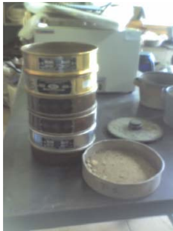
Figura 5. Tamices: \frac{3}{4} , 4, 10, 40 y 200, de abajo hacia arriba.
