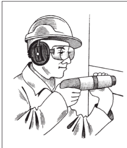
Figura 41. Protección de ojos y oídos durante el uso de una pistola de cartuchos. El operador lleva también casco.
