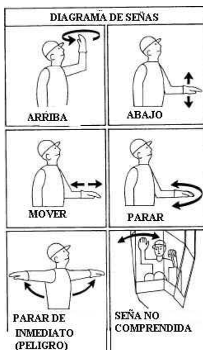
Figura 33. Las señas con la mano a los operadores de grúas: deben ser claras y precisas, ajustándose a un código o sistema reconocido.
