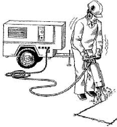
Figura 1. Control del ruido de un compresor: cerrar las tapas, usar amortiguador de ruido en el martillo rompe pavimentos, ponerse orejeras.
